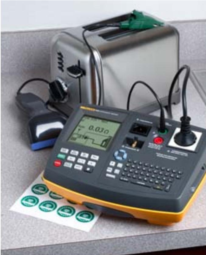
它提供了“一键测试”功能，具有基本的储存和打印能力。一键式测试功能是指用户只需按一个按钮即可启动任意测试。
