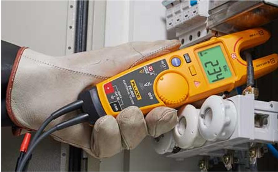
[可同时测试电压/电流的变频器钳表：福禄克安博 ACD-14-PRO](#)
