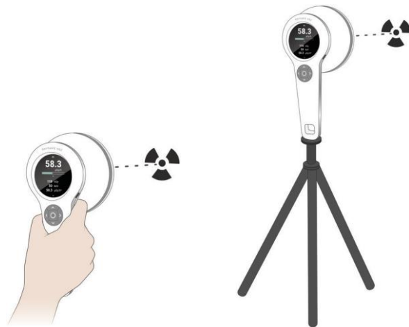
图 3. 将传感器区域朝向辐射源。
